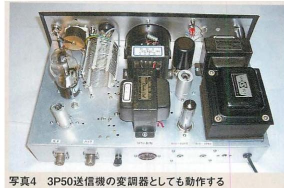
写真4 3P50送信機の変調器としても動作する
