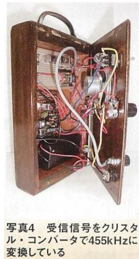
写真4 受信信号をクリスタル・コンバータで455kHzに変換している
