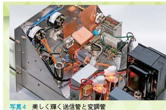
写真4 美しく輝く送信管と変調管
