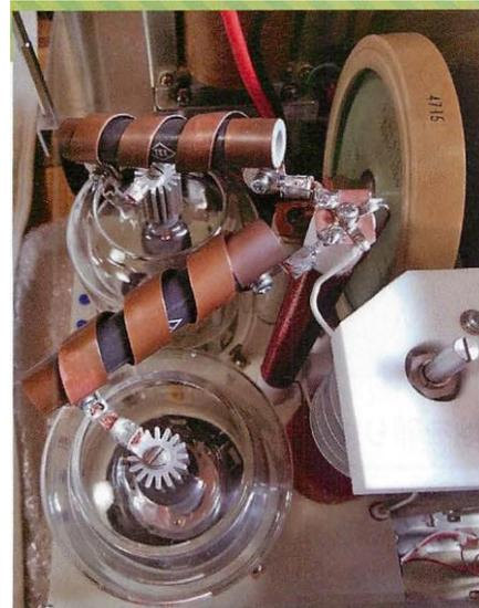
写真5 新スプリアス規格対応のために製作した第2高調波低減用のローパス・フィルタ
