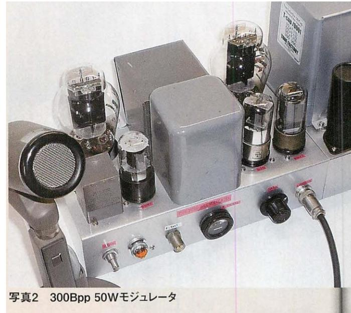
写真2 300Bpp 50Wモジュレータ
