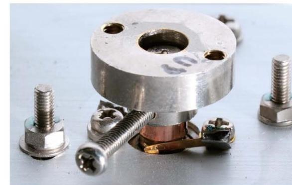
写真4 ダイアルを外したバリコンのシャフト部分
