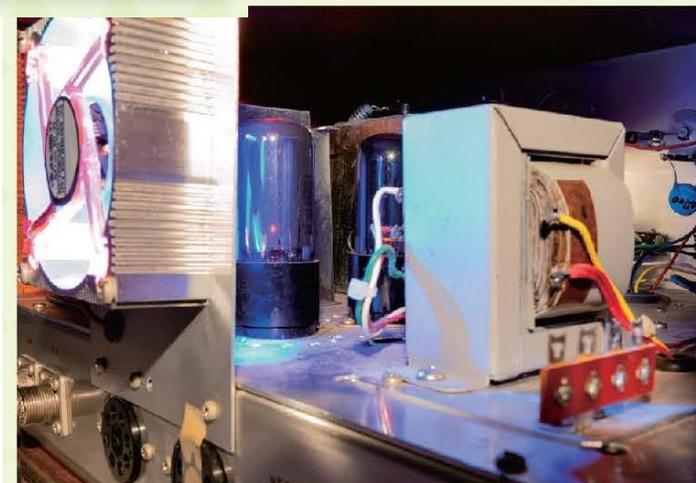
写真5 変調管を6V6に換装した本機
