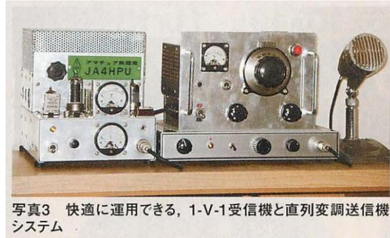
写真3 快適に運用できる、1-V-1受信機と直列変調送信機システム
