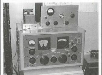
元気なJA1AVR 石田OMのSP-600受信機(写真下)と自作の4D32送信機
