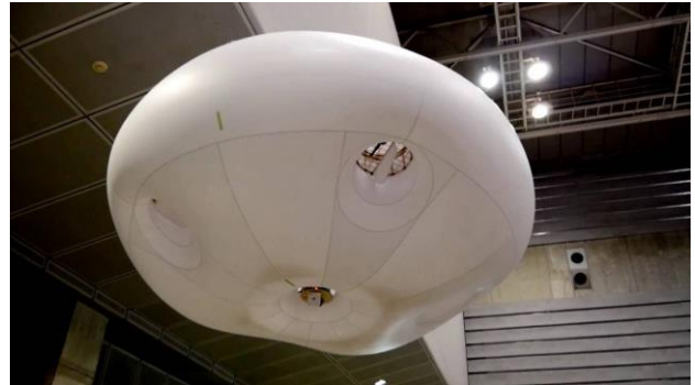
バルーン型ドローン「エアコクーン」 (ドローンワークス)
