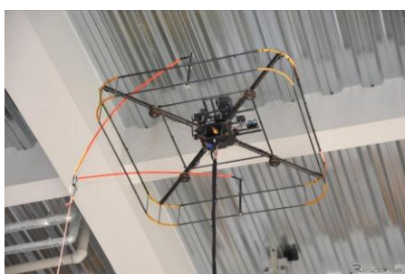
道路橋点検用ドローン (NEXCO中日本)
